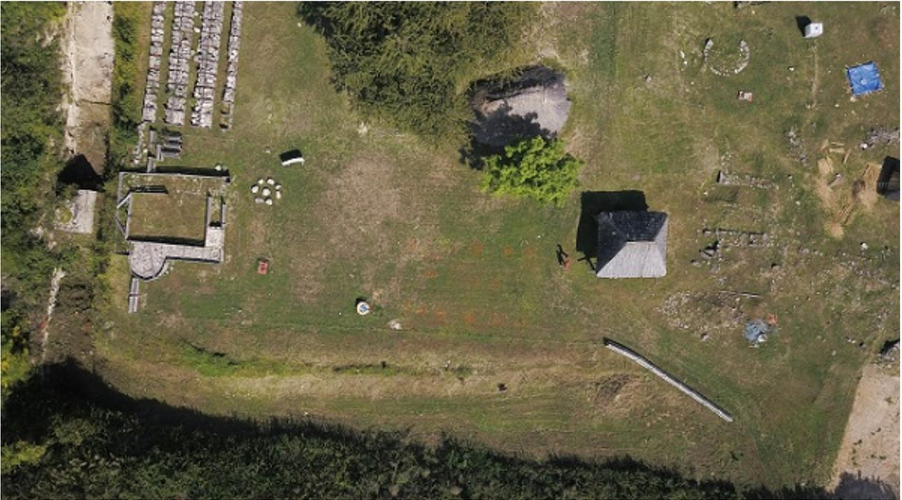
Figure 4.4 – report du plan du bâtiment 10 sur le terrain à l'aide de peinture.
