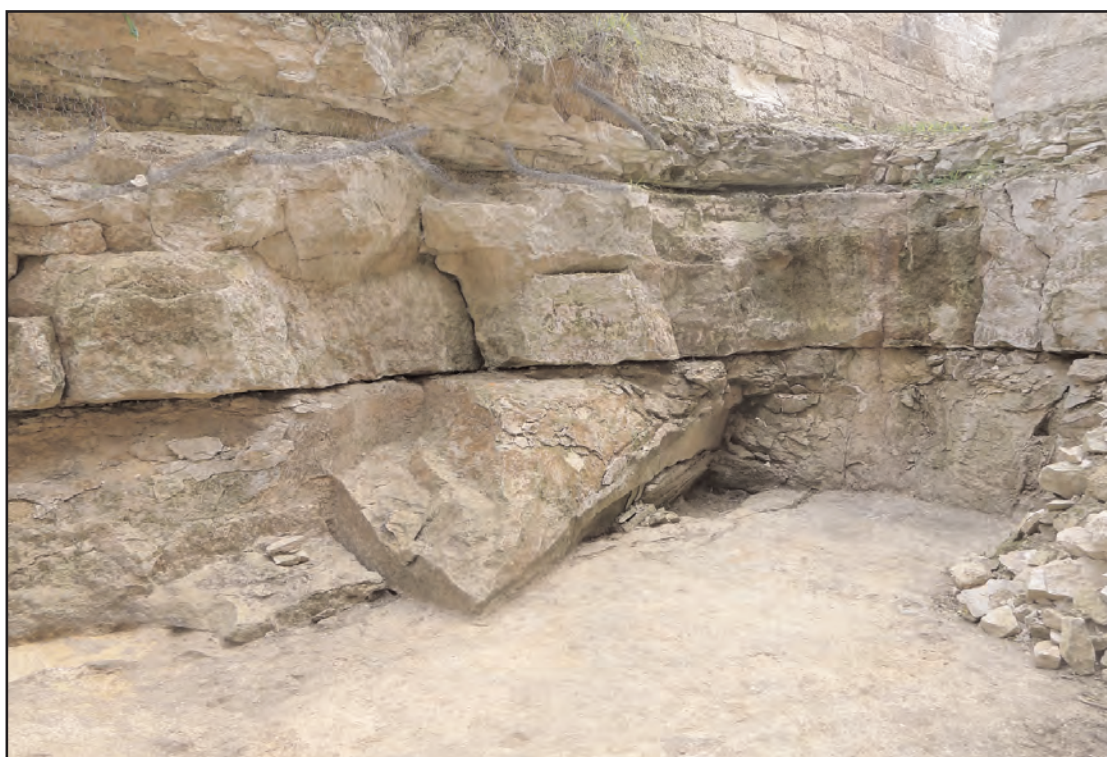
Fig.71a Abattage raté d'un bloc : tranche de défermage perpendiculaire à la fissure tectonique
