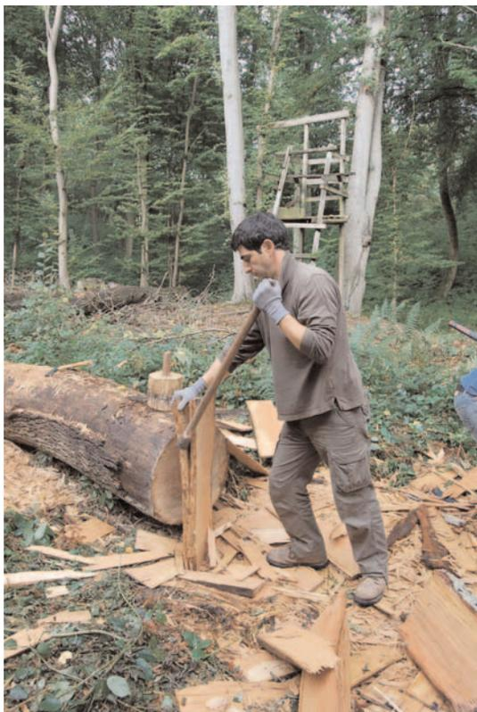
Fig. 6 : Basculement du départoir pour provoquer le clivage du bois
