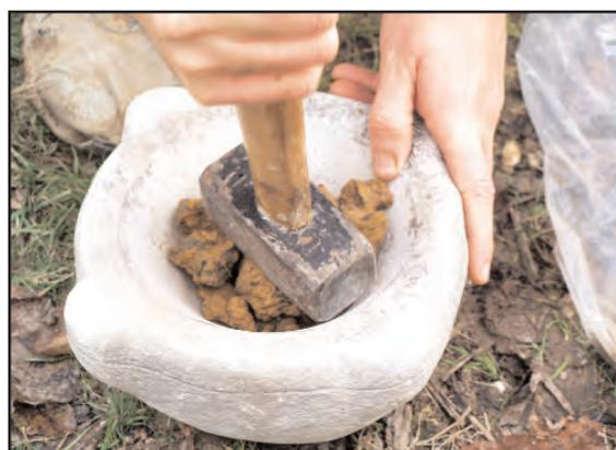
Fig. 82 : concassage du minerai
