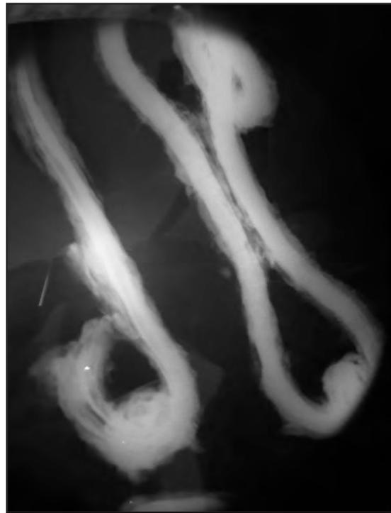
Fig. 65 : radiographies des éléments de chânes de pont levis
