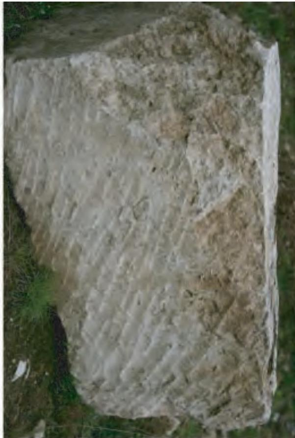
A droite, cliché des traces d'impacts laissées par l'emploi du taillant droit sur le lit d'un bloc du château d'Orville, en-dessous, traces de polka.
