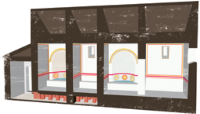
Les bains dits du «régisseurs» dans la villa du Thillay (95) avec sa succession de pièces, de droite à gauche, des pièces les plus froides aux plus chaudes, alimentées par le foyer à l'extrémité gauche.
